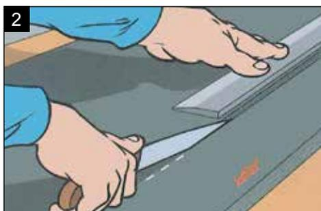
Частично снимите защитную ленту с одного конца изоляции.
