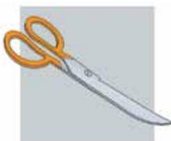
Ножницы для резки изоляционного материала
