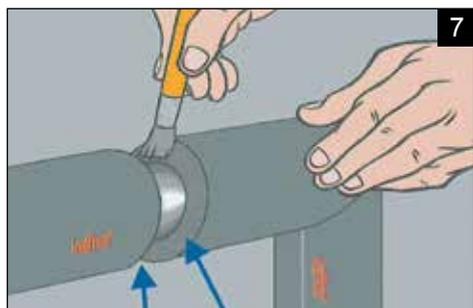
7 Аккуратно нанесите клей на торцы детали. Завершите монтаж теплоизоляции на 90° изгибе трубопровода, присоедините его к соседним участкам теплоизоляции на трубопроводе.
