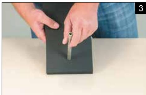
Разрезать полосу материала KAIFLEX длины периметра изоляции с учетом толщины хомута + минимальную толщину изоляции. Пробойником проделайте отверстие для крепежного болта.
